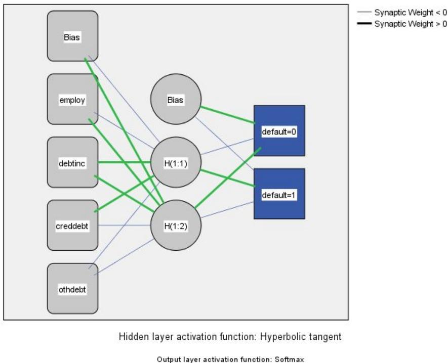
Figura 1. Arquitetura Feedforward com uma estrato oculta
